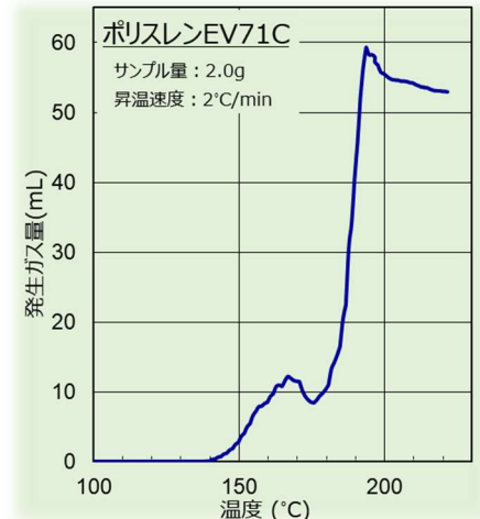
開発品の昇温下におけるガス発生図
